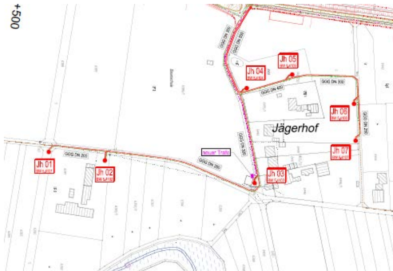
Abb.: Grundwasserhaltung Burkheim-Jägerhof (Quelle: Planunterlage 14.1 - Lageplan Grundwasserhaltung Jägerhof BW 5.4)
