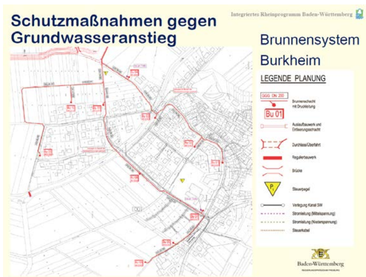
Abb.: Grundwasserhaltung Vogtsburg-Burkheim (BW 5.5) (Quelle: Regierungspräsidium Freiburg, Präsentation Foliensatz 14 - Folie 11)
