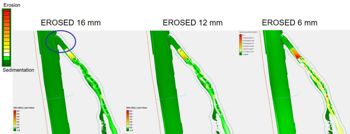
Abbildung 111: Maßnahme M42 – Auslaufbereich, Prognose der morphologischen Entwicklung mit Erosionsintensität und Sedimentation (EROSED für verschiedene Korngrößen)
